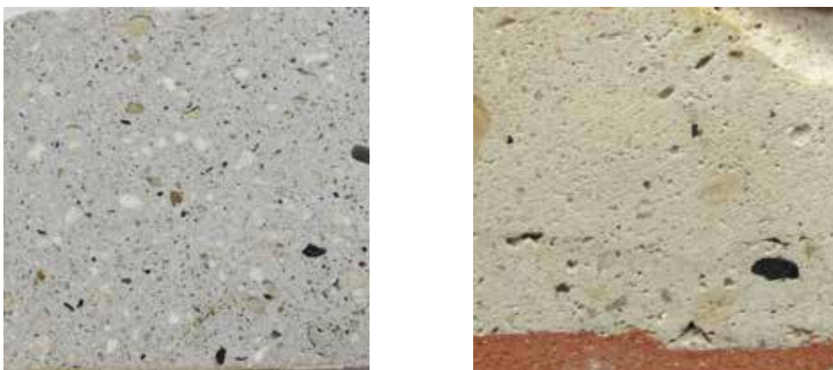
Fig.150. Plâtre gris (coloré par la cendre) à gauche, plâtre blanc à droite. Les deux contiennent des charbons. Source : Jean Ducasse-Lapeyrusse.
