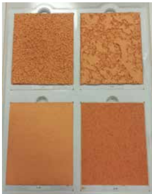
Fig.73. Quatre échantillons d'enduits de plâtre Parex-lanko : des plâtres de même teinte mais de textures différentes ne sont pas perçus de la même manière par nos yeux. Source : Tiffanie Le Dantec.
