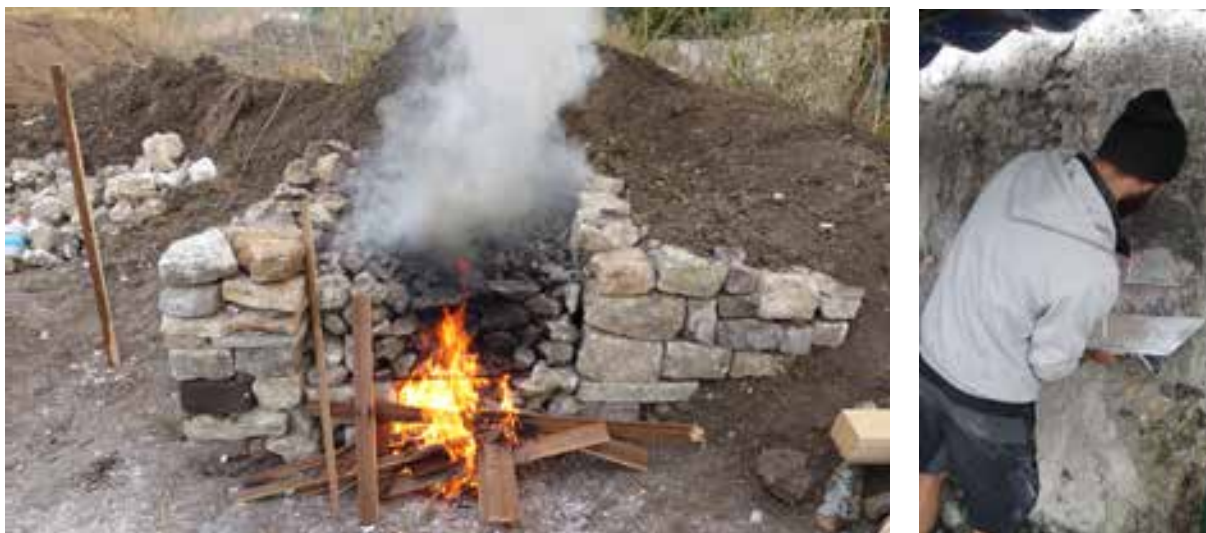
Fig.201. Cuisson des plâtras et mise en oeuvre du produit obtenu, formation sur le site des Murs à Pêches de Montreuil. Source : Tiffanie Le Dantec et Jean Ducasse-Lapeyrusse.
