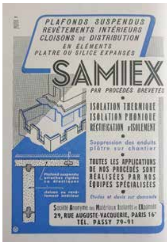
Fig.171. Encart publicitaire pour le procédé de plaques de plâtre Samiex, vantant la suppression des enduits sur les chantiers. Source : Techniques et Architecture , 1948, 8e année, n° 1-2.
