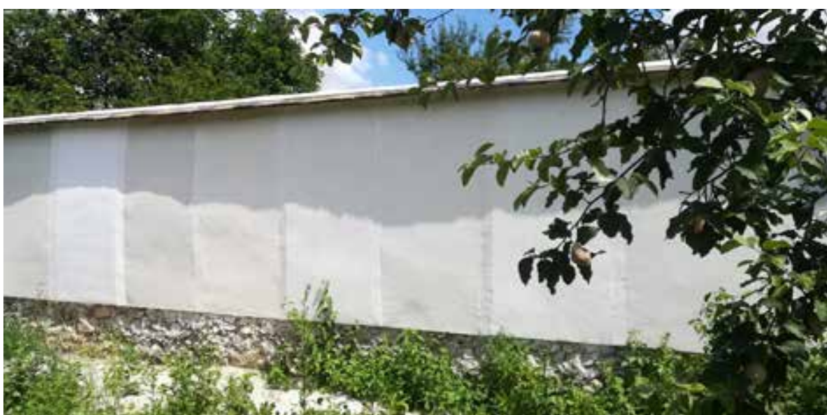
Fig.198. Tests de vieillissement naturel d'une dizaine d'enduits du marché et sur-mesure, qui seront analysés par le LRMH au cours des années futures. Site des Murs à Pêches de Montreuil. Source : Tiffanie Le Dantec.
