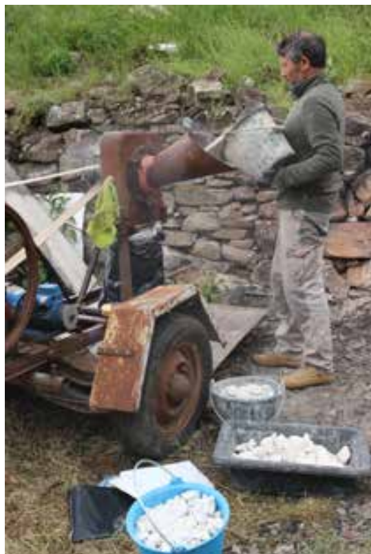
Fig.44. Obtention de poudre de plâtre par deux procédés. Le broyage mécanique (à gauche) à l'aide d'un broyeur à maïs et le broyage traditionnel (en haut à droite) par battage de plâtre cuit. La poudre obtenue par les deux techniques est d'une granulométrie variée (en bas à droite). Source : Tiffanie Le Dantec.
