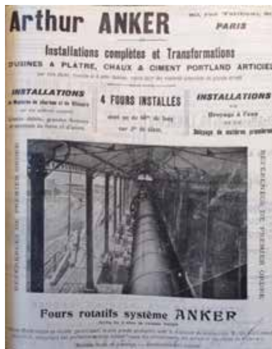
Fig.138. De nombreux fours et broyeurs font partie d'usines tout équipées proposées à la vente au début du XXe siècle. A droite on observe un four rotatif. Sources : (Gauche) Revue des Matériaux de Construction et de Travaux Publics, octobre 1911, n° 78, p.5. (Droite) Revue des Matériaux de Construction et de Travaux Publics, 1910, n° 68, p.7.
