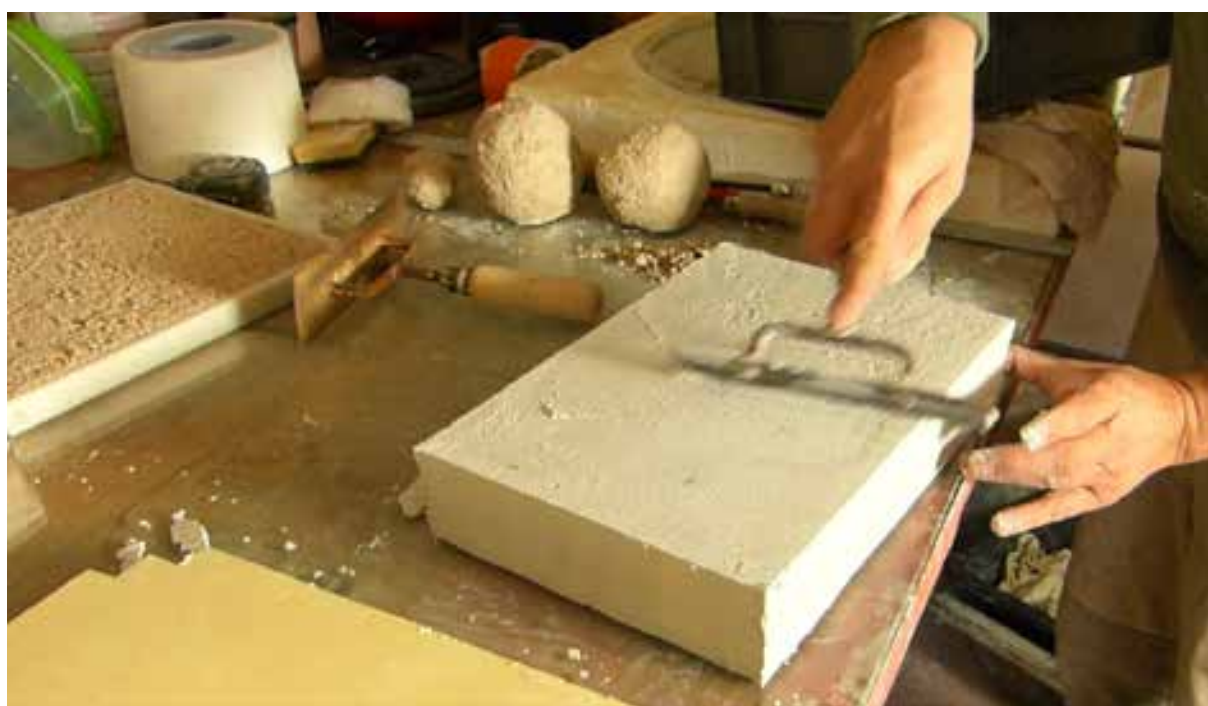
Fig.45. Deux enduits de plâtre dressés à la berthelée. A gauche, l'enduit provençal de couleur rose à la surface très granuleuse. A droite, l'enduit parisien de couleur blanche dont la surface est lisse. A conditions de fabrication et de mise en oeuvre égales, ces enduits sont différents grâce au gypse utilisé.
