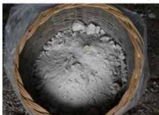
Fig.44. Obtention de poudre de plâtre par deux procédés. Le broyage mécanique (à gauche) à l'aide d'un broyeur à maïs et le broyage traditionnel (en haut à droite) par battage de plâtre cuit. La poudre obtenue par les deux techniques est d'une granulométrie variée (en bas à droite). Source : Tiffanie Le Dantec.
