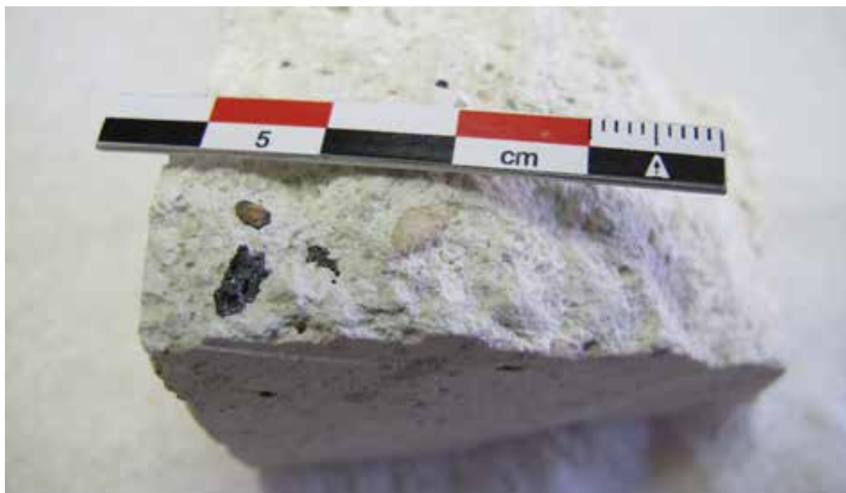
Fig.39. Fragment d'enduit de plâtre prélevé sur le Théâtre de la Renaissance (Paris). Dans la matrice on observe du coke (grain noir brillant et poreux) et du gypse incuit (grain beige cristallisé). Source : Jean Ducasse-Lapeyrosse, LRMH, 2015.
